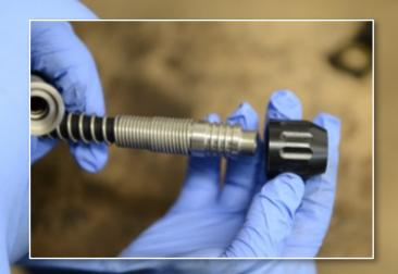
INSERT THE GREASED TRANSMISSION CABLE BACK INTO THE DRIVE CABLE OUTER SHEATH UNTIL BEARING IS FLUSH WITH THE BASE.
