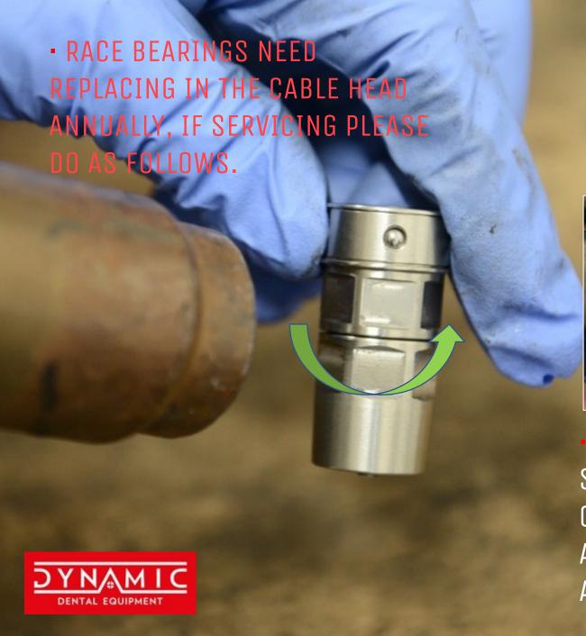
• GENTLY HEAT USING A HEAT GUN AROUND THE AREA HIGHLIGHTED IN THE PICTURE
